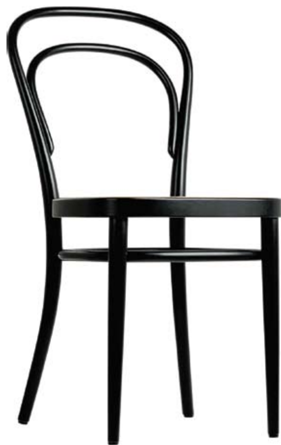
A cadeira Thonet 214, antiga n° 14, é um marco na história do mobiliário moderno. A madeira maciça, tornada flexível pela ação do vapor, era curvada em moldes de metal
